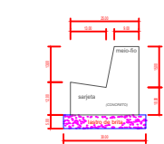
Secção Transversal Tipo escala 1:20
